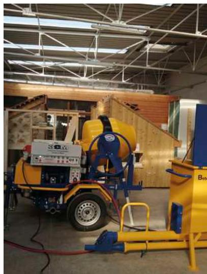
Machine à projeter l'enduit chaux chanvre acquise par le Parc
