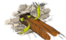
Espaces subsistants dans les logements des pannes dans la maçonnerie
